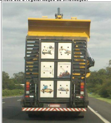
Semirreboque com carga excedente, com excesso lateral, e sem sinalização traseira.
